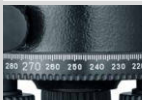
Cerchio azimutale con azionamento laterale di precisione senza fine per un puntamento preciso.
